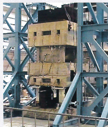
阪神大震災の鷹取波(125kine)を受けても損傷はほとんどなく、水平・鉛直耐力保持しています。
